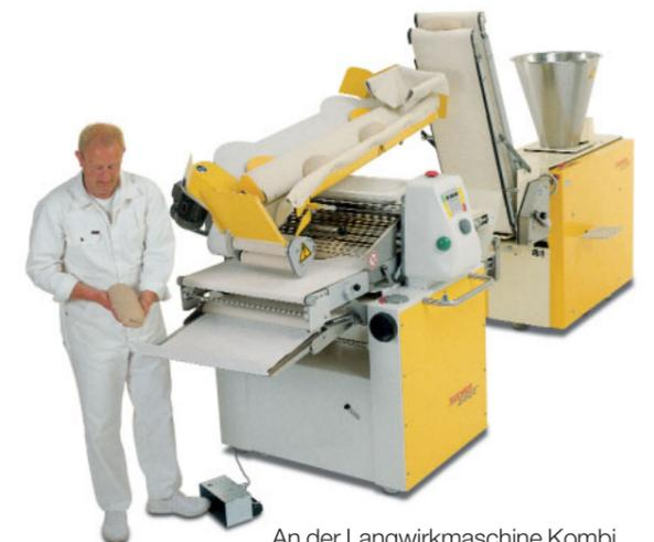
An der Langwirkermaschine Kombi stehend, also direkt am Produktionsausstoß, kann eine Person durch Fernschaltung den Arbeitsablauf kontinuierlich steuern (Fußschaltung).
