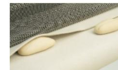
Herstellung von Schrippen. Aufgelegte Brötchen-Teiglinge werden ausgewalzt und eingeschlagen. Sie können dann schlussgerecht abgesetzt werden.
